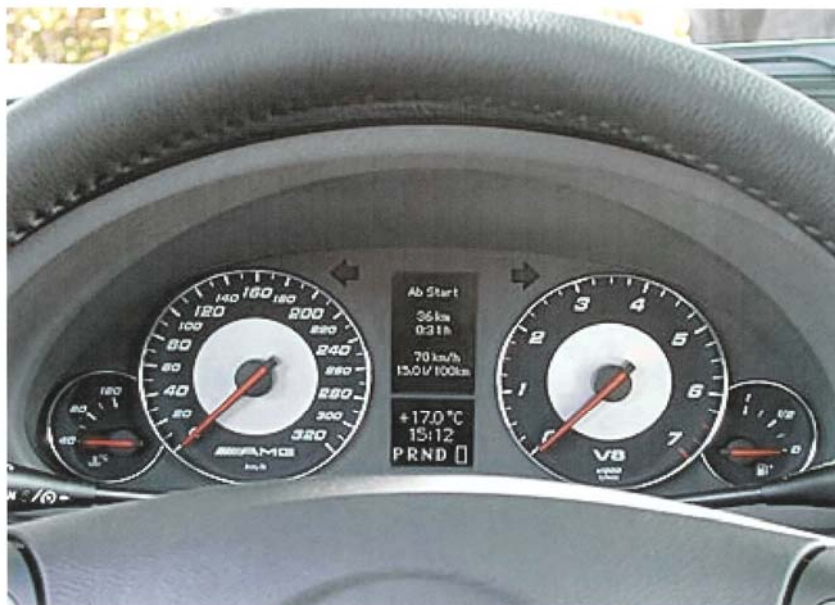
Bild 5.5: Kombiinstrument Mercedes C-Klasse Baujahr 2004 (auch bei BMW, VW u.a.).
