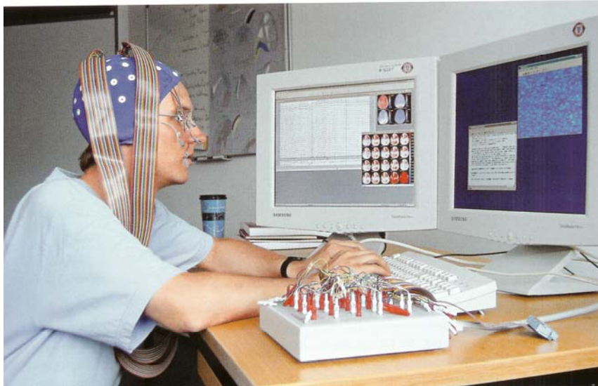
Bild 6.16: 128 Sensoren messen Hirnströme für Handlungserkennungssystem (FhG FIRST) 3 .
